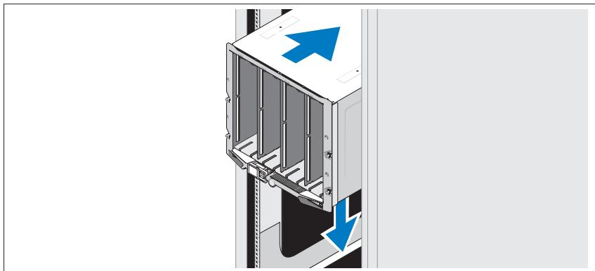
Monte os trilhos e instale o sistema no rack seguindo as instruções de segurança e as instruções de instalação do rack fornecidas com o sistema.
