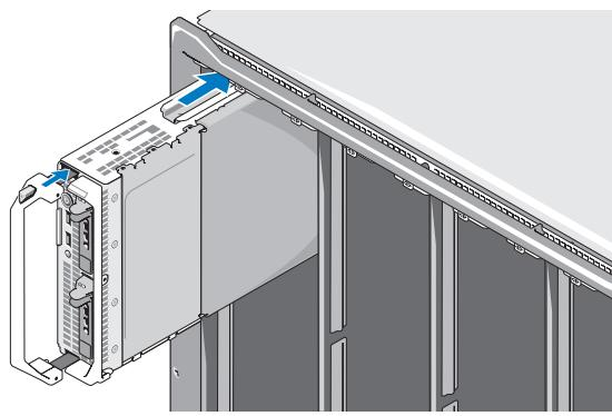
Empezando por la parte superior, inserte los módulos en el alojamiento de izquierda a derecha. Una vez que el módulo de alta densidad esté bien instalado, el asa volverá a la posición de cierre.
