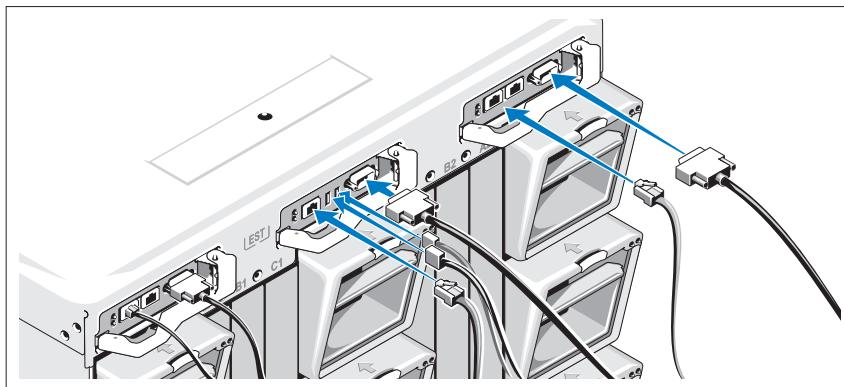
Conecte os cabos serial e de rede do sistema de gerenciamento ao módulo CMC. Se um segundo módulo CMC opcional estiver instalado, conecte-o também.
