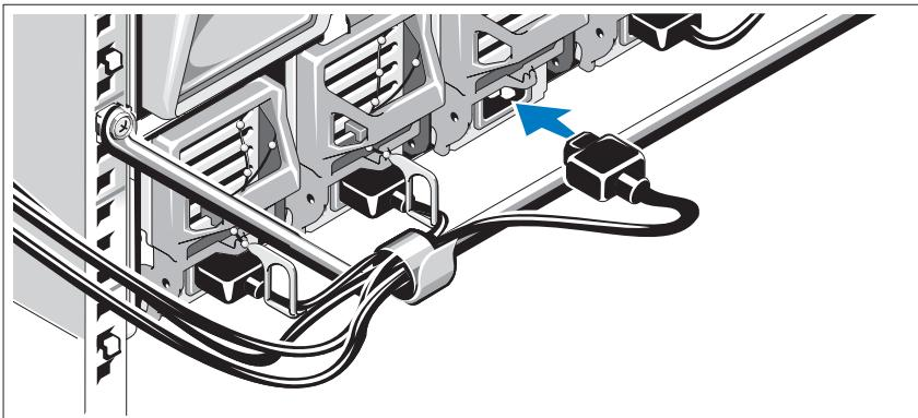
Conecte os cabos de alimentação do sistema às fontes de alimentação.
