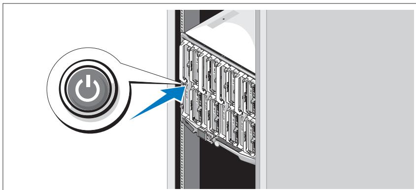
Mettez chaque lame sous tension en appuyant sur son bouton d'alimentation ou en utilisant le logiciel de gestion des systèmes.
